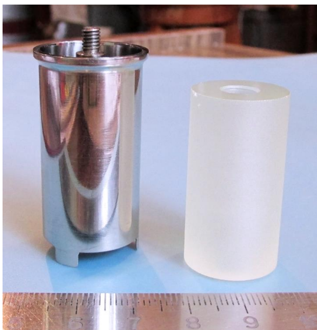
Рисунок 3.29 – Монокристаллический образец \text{BaWO}_4 (справа) и калориметрическая ампула (слева). Шкала линейки в сантиметрах.
